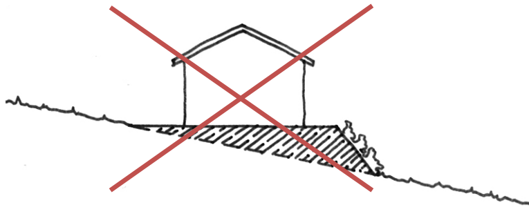
la mise à niveau par talutage
