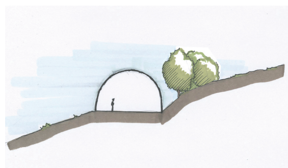
Exemple : tunnel agricole sur une plateforme en déblai, adossé à une haie plantée
